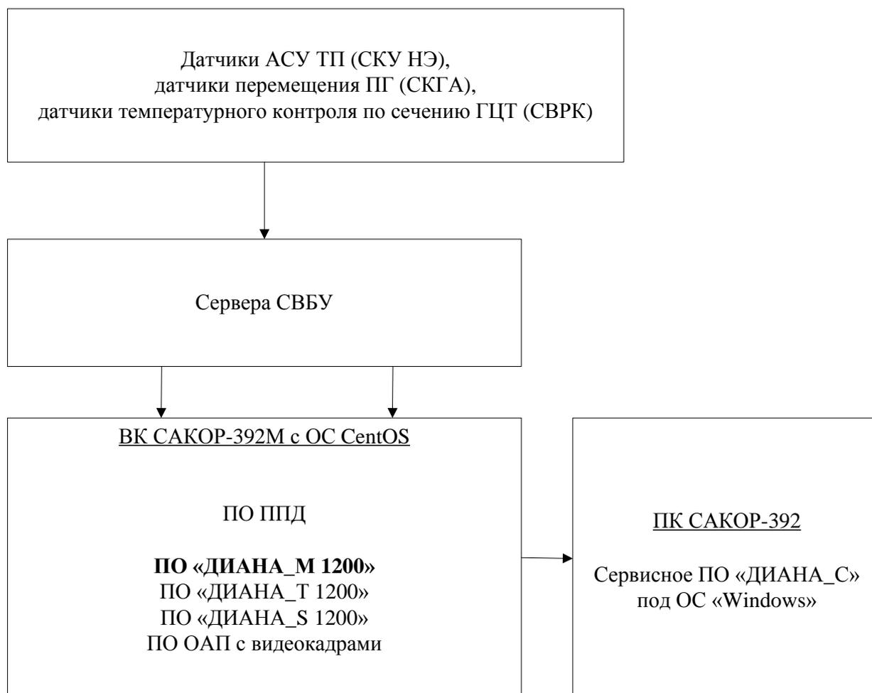
Рисунок 2.1 - Принципиальная схема передачи информации на ВК САКОР-392М
